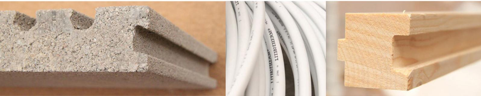
**Lithotherm ist ein Raumklimasystem zur Regulierung der Temperaturen in Wohn- und Arbeitsbereichen.** Herzstück des Systems ist die vorkonfektionierte LITHOTHERM-Formplatte. Sie besteht aus den Natursteinmaterialien Lavasplitt, Kalksplitt und Tongranulat. Diese Masse dient nicht nur als Wärmespeicher in der Hauptheizperiode – sie trägt auch zur Schall- und Trittschallreduzierung bei.
